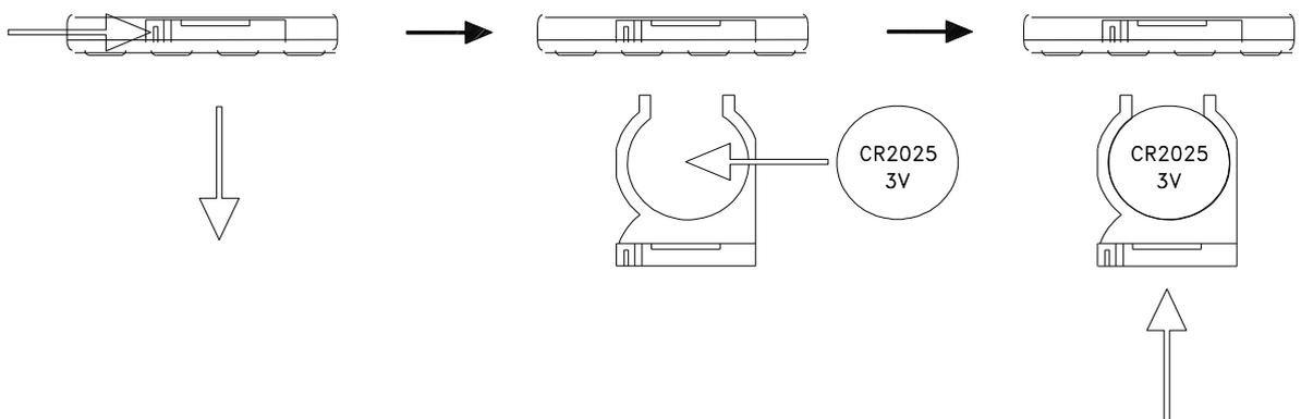
Appuyer et tirer sur le loquet qui se trouve sur la partie gauche du logement de la pile ; tirer ensuite sur le logement de la pile.
