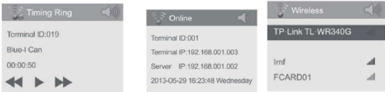
Le terminal obtiendra la tâche à exécuter du serveur lorsqu’il est connecté, et enregistre et accomplit la liste des tâches via sa mémoire interne. Il peut aussi recevoir un appel et procèdera donc à l’unicast, multicast ou broadcast de la communication.
