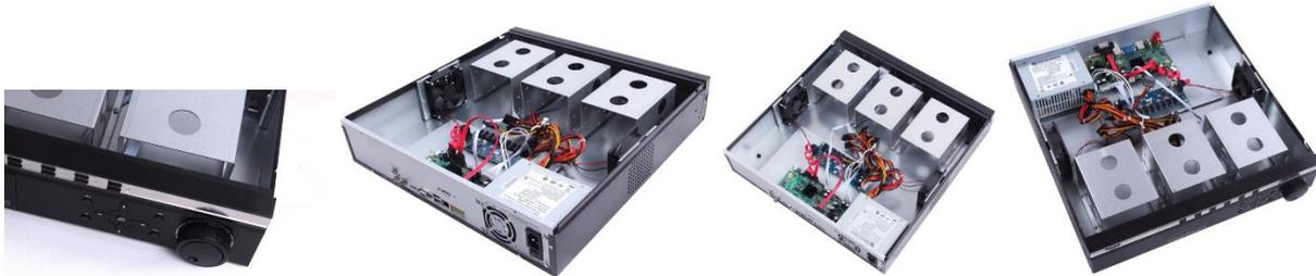
Le PT-NVR32IP est un enregistreur NVR 32 canaux IP, dont le fonctionnement est basé sur le système d'exploitation Linux, ayant un processeur puissant pour le traitement vidéo et le stockage des données. Il peut enregistrer 32 canaux vidéo en simultanément en résolution 720p ou bien 9 canaux en 1080p. Il adopte la compression H.264 et MPEG-4 pour un meilleur rendement, tant sur le plan de la qualité vidéo que sur le stockage.
