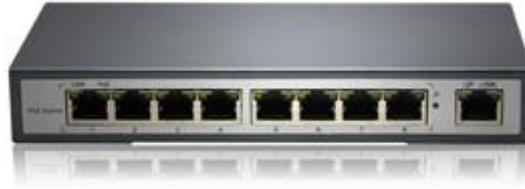
Le switch PoE-S8 est un module d'alimentation Power over Ethernet professionnel équipé de 9 ports RJ45 10/100Mbps, supportant jusqu'à 8 caméras IP pour la transition des données et de l'alimentation par un seul câble Ethernet. Cet appareil répond aux protocoles standards comprenant IEEE 802.3i 10BASET, IEEE 802.3u 100BASETX, contrôle du flux IEEE 802.3x, IEEE802.1af DTE Alim via MDI, IEEE 802.3af.
